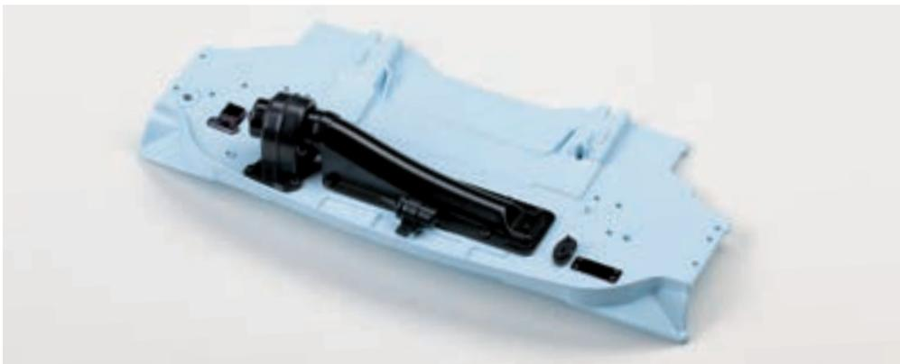
Выше установленного ранее кожуха радиатора отопителя поместите и закрепите винтом 1,7×3 (FM) катушку зажигания. Обратите внимание: при правильном монтаже высоковольтный вывод катушки ориентирован в сторону мотора отопителя (влево). Во избежание поломки кронштейна катушки зажигания не прилагайте излишних усилий при фиксации детали.
